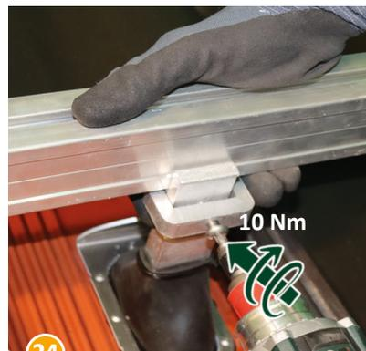
24 ...und die Position durch Anziehen der Schraube (10 Nm) fixieren.
