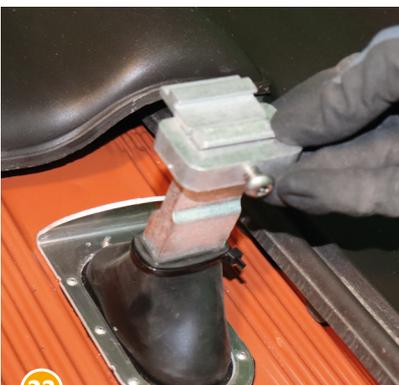
23 Die Klemmkombination wieder auf die Konsole stecken, das Tragprofil auflegen, einhängen, dabei die Höhe durch die Klemmkombination an der Konsole anpassen...
