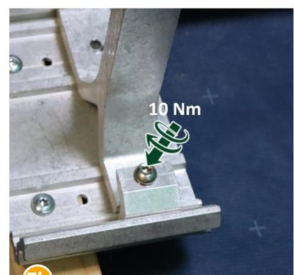
**7b** Position durch Anziehen der Schraube (10 Nm) fixieren.
