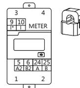
Contador monofásico DDSU 666 con firmware Solarwatt
